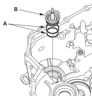
2. 将 ATF 供油管盖安装到变速器壳体中。不要挤压 O 形圈。
