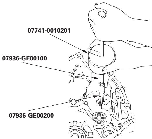
2. 使用专用工具, 将新轴承安装到变速器壳体中。
