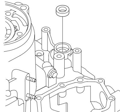
2. 使用专用工具将新油封安装到变速器壳体中。
