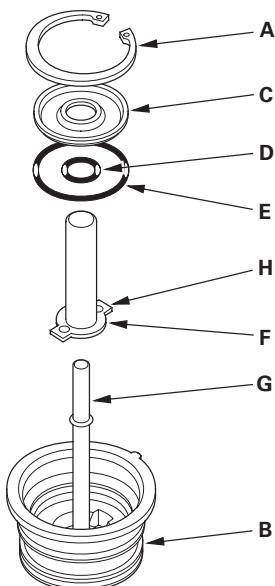
3. 更换一档离合器 ATF 供油管或一档保持离合器 ATF 供油管 /ATF 供油管盖总成。不能单独购买一档保持离合器 ATF 供油管 /ATF 供油管盖。
