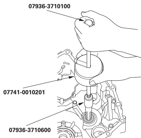
2. 使用专用工具, 安装新轴承, 直至其接触变速器壳体。
